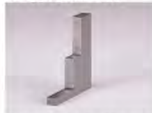
SKD11材10-50-100mm厚 Φ0.25 黄铜丝 4次加工 形状精度 ±3.0μm 光洁度 Ra 0.36μm
