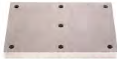
SKD11材25mm厚 Φ0.25 黄铜丝 6次加工 Φ15mm 步距精度 -1.2μm~+1.0μm
