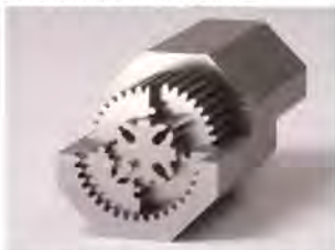
SKD11材40mm厚 Φ0.20 黄铜丝 4次加工 形状精度 ±3.0μm 光洁度 Ra 0.30μm
