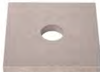
SKD11材20mm厚 Φ0.25 黄铜丝 6次加工 Φ50mm 真圆度 0.90μm
