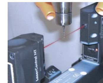
整体式系统能够为小刀具测量提供最高的精度
