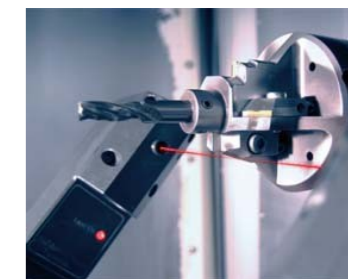
快速检测刀尖上的微量磨损
